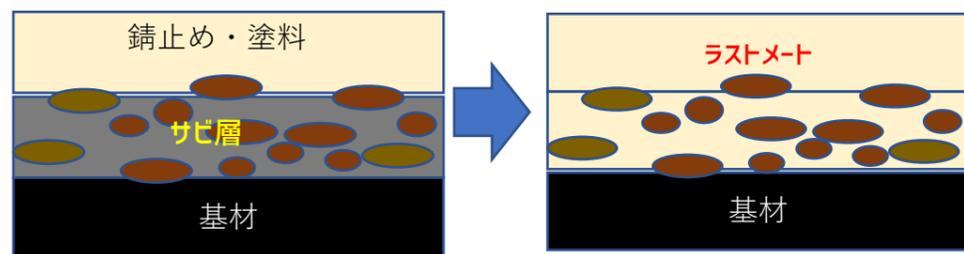
サビの上に塗料が乗っている状態。サビの層は、塗膜のピンホールから侵入する水分や空気の通路となり、錆が成長して塗膜を破り表面に錆が現れる。防水機能が弱いので、層間剥離が起きやすい、
