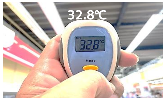
断熱塗装あり室内天井温度
