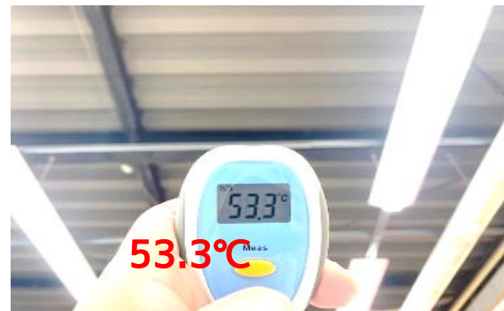
断熱塗装なし室内天井温度
